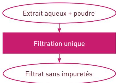
L'extrait aqueux est traditionnellement filtré à l'aide d'un tamis grossier, avant d'être passé sur du coton qui permet d'obtenir une filtration plus fine. En utilisant la poudre, la filtration est réduite à une étape : filtration sur coton.
